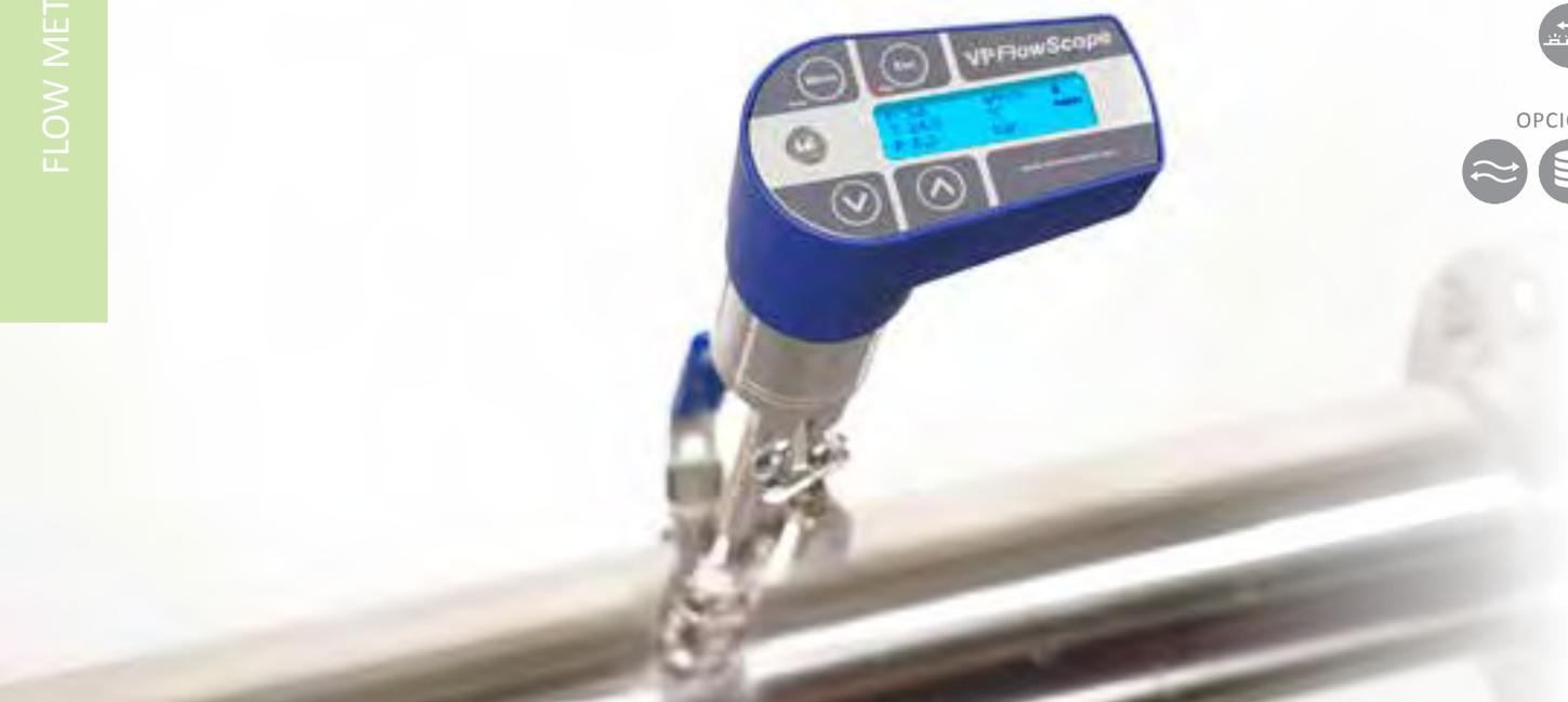
El VPFlowScope® Probe es la herramienta de medición para aire comprimido seco y otros gases industriales, incluyendo oxígeno, nitrógeno, CO<sub>2</sub>, helio y argón. El VPFlowScope Probe mide simultáneamente el flujo másico térmico, la presión, la temperatura y el flujo total.
